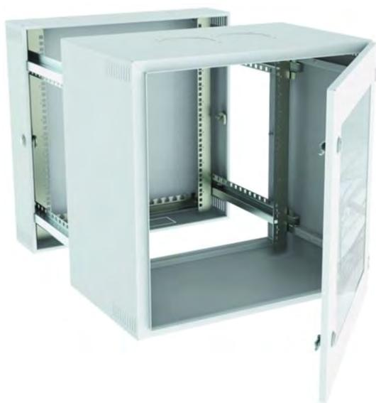
Используются для установки пассивного, активного телекоммуникационного оборудования, ВОЛС. Чаще всего используются в офисах для создания этажных узлов коммутации, а также провайдером при создании домашних сетей. Шкаф в 3-секционном исполнении имеет оптимальный доступ к оборудованию.
